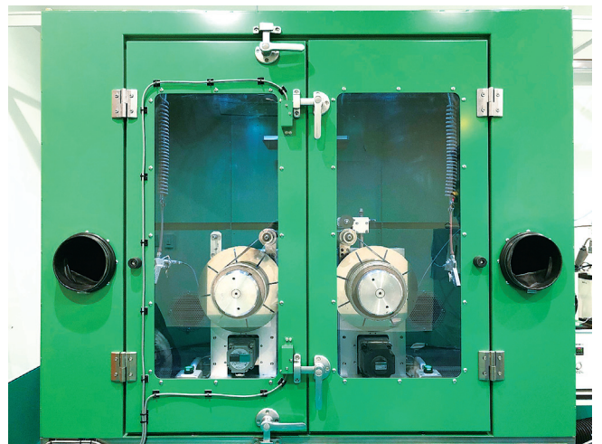
埼玉事業所に導入した自社開発のCS法連続被覆設備
