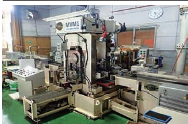
20年に改造が完了した多機能・張力圧延機に、ターゲットとする温度での焼鈍調整が容易になり、金属の内部組織をより精緻に整えることが可能となる。現在試運転を行っている。
