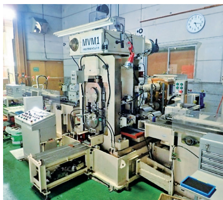
改造した多機能・張力圧延機
